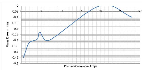
Los gráficos superiores muestran que el 590F3 HV del tipo de pinzas Clip-on pueden mantener una precisión mayor que  $\pm 0.1\%$  en la precisión de RT desde los 5 hasta por encima de los 100 Amps.
