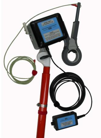
**C) 590F2** es un TC de LV del tipo Clip-On, de 415 a 600V primario. El circuito de compensación para las pinzas de baja tensión se ubica en forma interna en el 590G-V2 .
